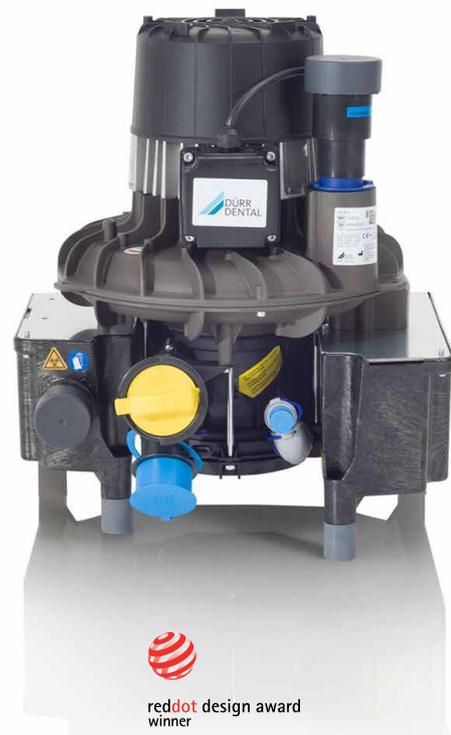
Con una depresión correspondiente a la máquina, se aspira a través de la cánula de aspiración una cantidad de aire de 300 l/min. El rotor con aletas, la turbina de separación y la bomba de aguas residuales son accionadas por el motor.
